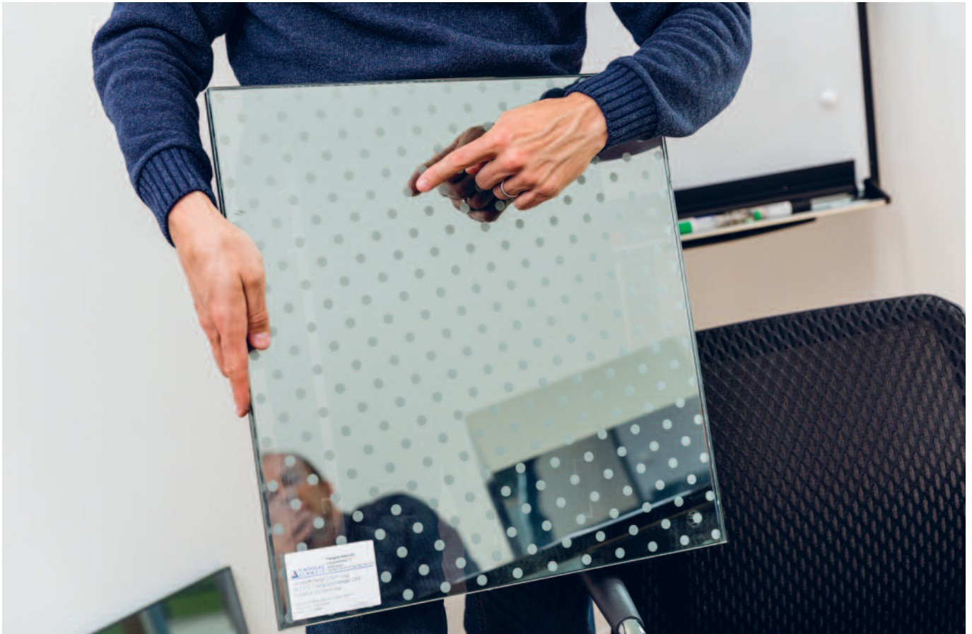
Musterplatte der Aussenverglasung.
